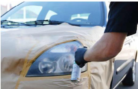
Mit dem 2K Klarlack wird nun in 1-2 Spritzgängen auf Hochglanz lackiert. Nach ca. 5-6 Minuten ist der Klarlack staubtrocken und nach ca. 7 Stunden (20°C) durchgetrocknet.
