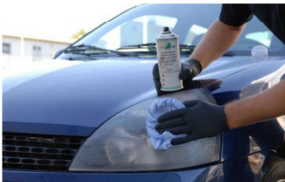
Nun das Schleifwasser mit Papiertüchern abrocknen und danach mit dem Kunststoffreiniger von ColorMatic reinigen. Andere Reiniger könnten die Kunststoff-Streuscheibe evtl. zerstören.
