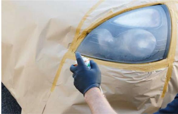
Der Kunststoff-Haftvermittler von ColorMatic wird in einem dünnen Spritzgang aufgetragen und gibt die nötige Haftung. Nach 8-10 Minuten Trocknungszeit (20°C) kann der 2K Klarlack appliziert werden.
