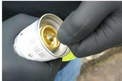
Mit dem Finger durch den Ring und kräftig bis zum Anschlag ziehen. Danach um 360° drehen.
