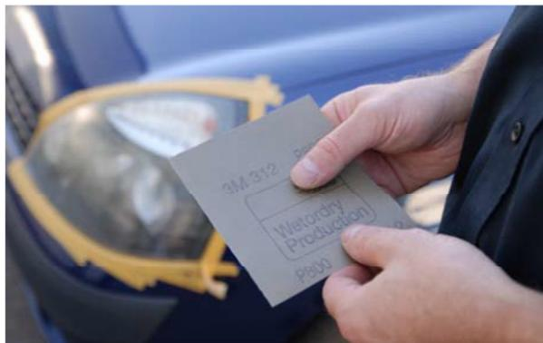
Gründlich Schleifen mit Nassschleifpapier P800, bis alle Vergilbungen entfernt sind.
