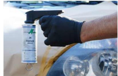
Nach dem Schütteln ist der 2K Klarlack einsatzbereit. Für ein Lackieren mit der Lackierpistole kann der beiliegende Spraymaster verwendet werden.
