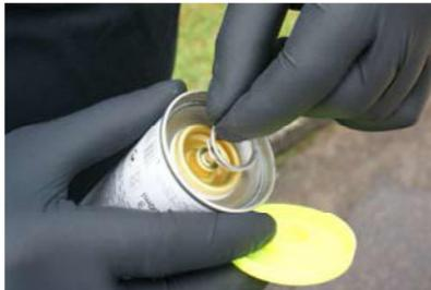
Vor dem Sprühen muss die zweite Komponente des Klarlacks aktiviert werden. Dazu den innen liegenden Ring aus der Schutzkappe nehmen und in den Stift einführen.
